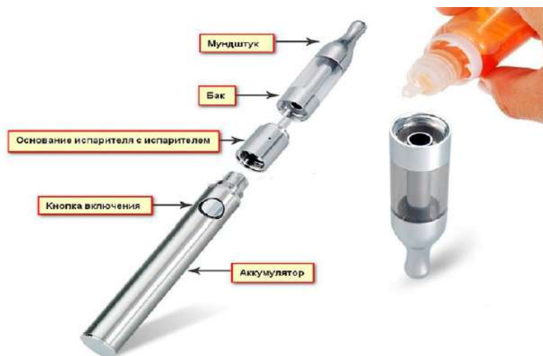
Рис. 3. Устройство электронной сигареты
